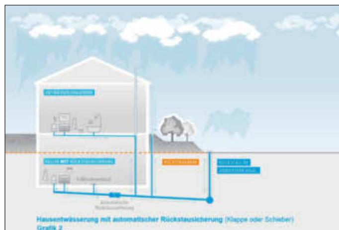
Diese Klappen oder Schieber lassen das Abwasser in der regulären Fließrichtung passieren. Sie schließen, sobald zurückstauendes Abwasser gegen die Fließrichtung drängt. Manuell zu bedienende Systeme sind unzulässig. Die Verwendung einfacher Rückstauverschlüsse ist nur dann möglich, wenn ein Gefälle zum Kanal besteht und es sich um „Räume untergeordneter Nutzung“ handelt.
